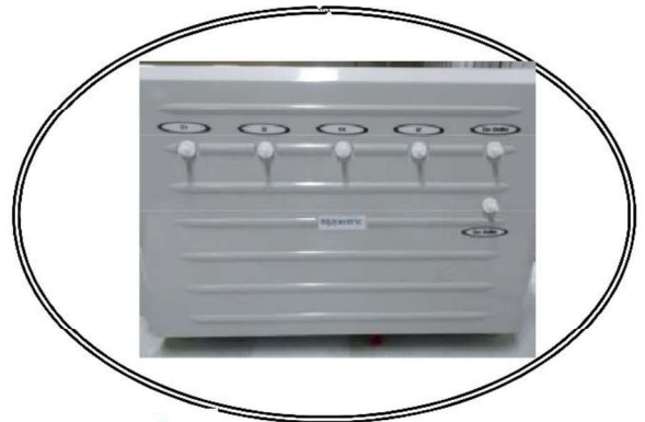
Panel prawy, podłączenie dla odczynników
